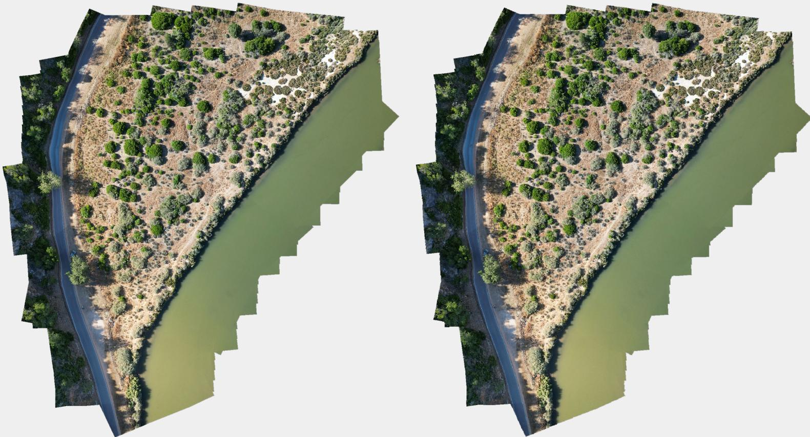
O ortofotomosaico processado em **Fast processing**, representado em EPSG 32629 (à esquerda) e em EPSG 3763 (à direita)...
